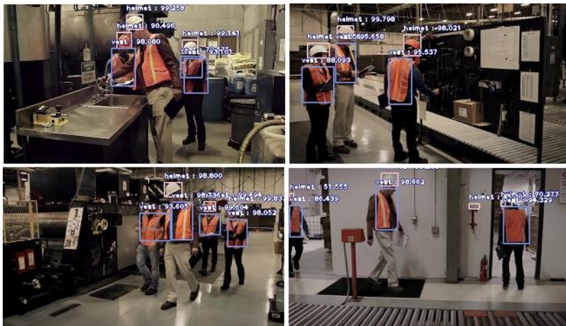
Рис. 7. Примеры обнаружения объектов на изображениях с помощью сверточной нейронной сети YOLOv3
